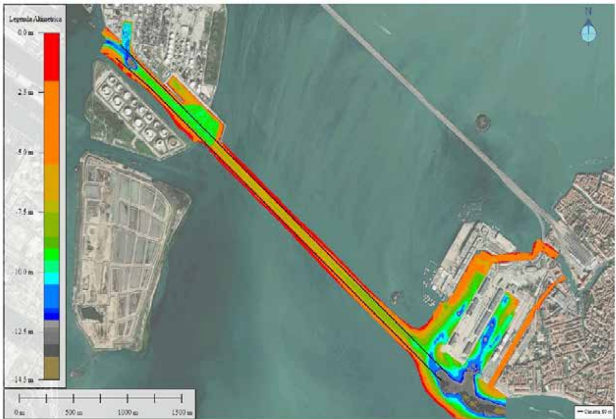
Fig. 1.10 – Planimetria di stato attuale (rilievo di febbraio-aprile 2023) con indicazione dell'ingombro della cunetta di larghezza 80 m
